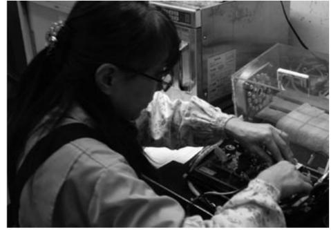
電子レンジ基板の性能検査
